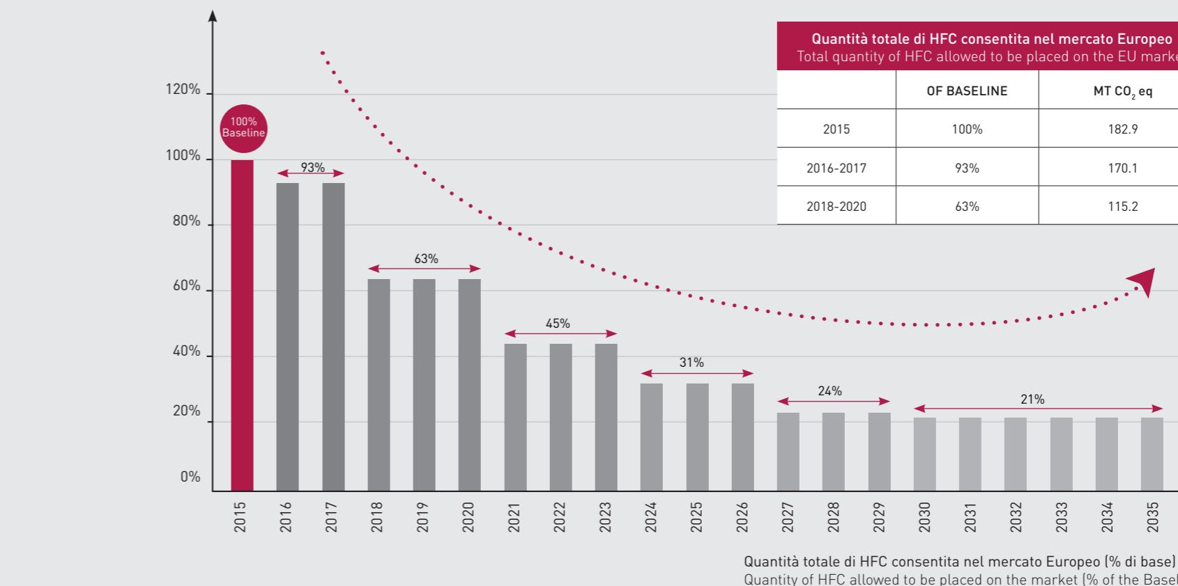
Step di riduzione della quantità di HFC espresse in CO<sub>2</sub> equivalente, tramite adozione del Regolamento Europeo Nr. 517/2014.
